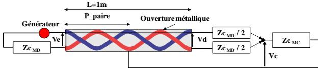
Fig. 4 Principe de la détermination des modes différentiel et commun.
