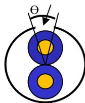
Fig. 1. Coupe transversale d'une ligne torsadée écrantée.
