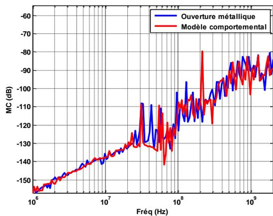
Fig 10: Transfert de mode commun obtenus en modélisant l'ouverture métallique puis par le modèle comportemental ( $l=1m$ )
