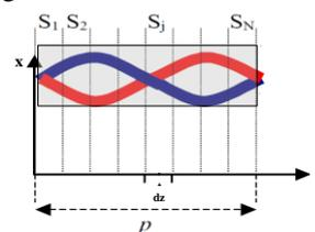
Fig.2 Approche physique de la modélisation d'une torsade
