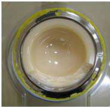
Figure 9. Cupule en alumine testée à sec. Rupture au bord inférieur.
