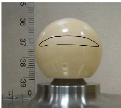
Figure 5. Tête testée à sec. En noir, les limites de la bande d'usure.
