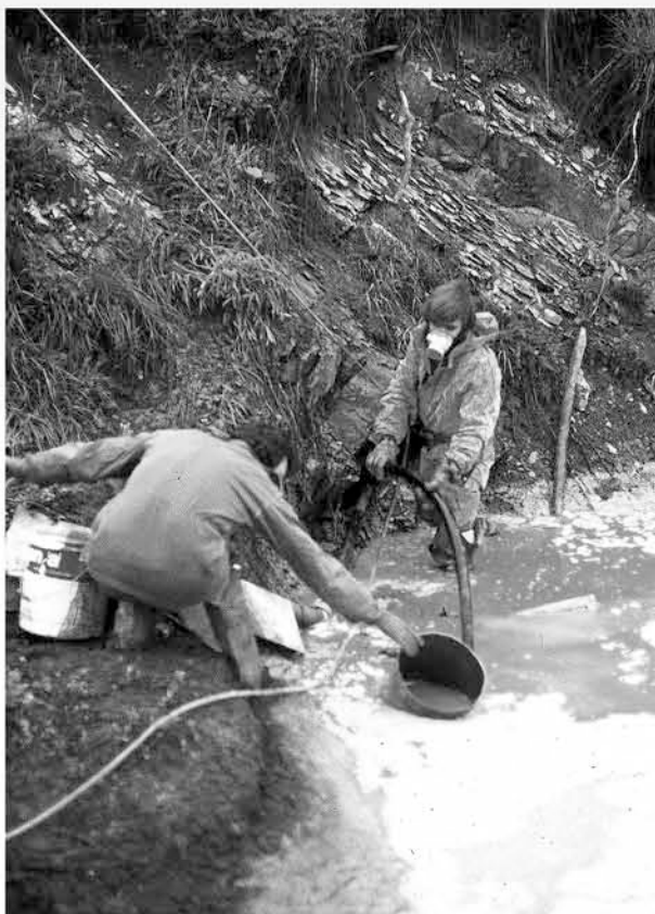
Fig.1 : Injection du traceur dans la doline de la Combe-aux-Prosts, remplie de lactosérum (les Moussières), 11 juin 1975. Robert Le Pennec (à droite) et Marcel Selva (à gauche).
