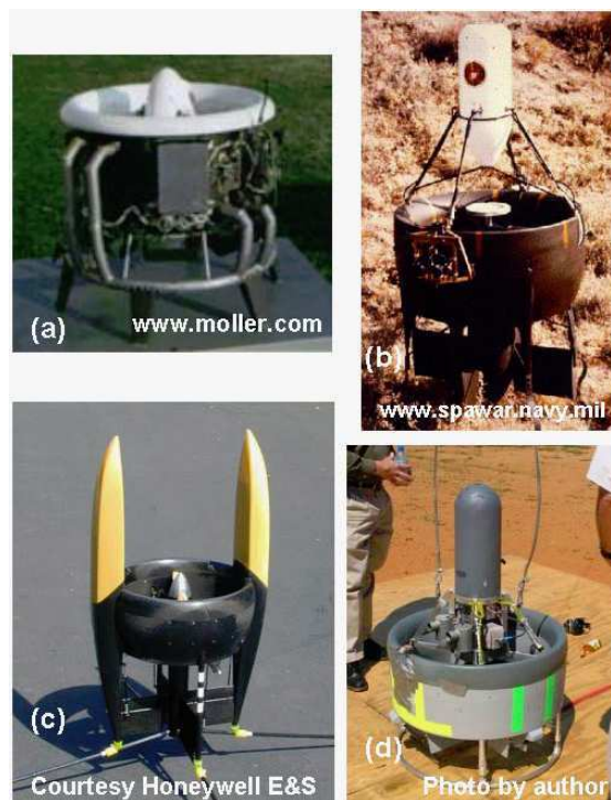
Figure 8 : exemples de VA à rotors carénés (figure extraite de [3]).
