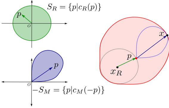
FIGURE 3 – **Somme de Minkowski.** La somme de Minkowski de  $S_R$  (objet de référence) et  $-S_M$  (symétrique de l’objet mobile) coïncide avec la description de la contrainte de non-chevauchement dans la figure 1.
