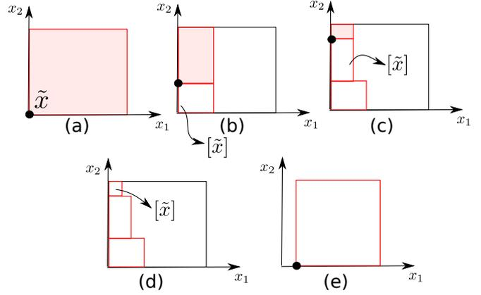
FIGURE 6 – Boucle de sweep. La séquence d’images illustre une contraction pour la borne inférieure de  $x_1$ . À chaque étape, le point  $\tilde{x}$  étendu est le coin inférieur-gauche de la boîte grisée. La boîte intérieure  $[\tilde{x}]$  est en blanc. La borne inférieure de  $x_1$  peut être réduite aussitôt que la projection des boîtes blanches sur  $x_2$  recouvre entièrement la face  $[x_2]$ , ce qui est le cas à l’étape e).
