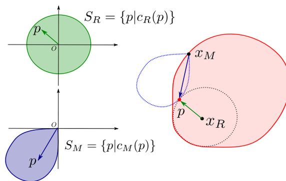
FIGURE 1 – **Contrainte de non-chevauchement.** *Gauche* : deux objets  $S_R$  et  $S_M$ . *Droite* : la région rouge représente l'ensemble de toutes les positions  $x_M$  pour  $S_M$  où la contrainte de non-chevauchement est violée.
