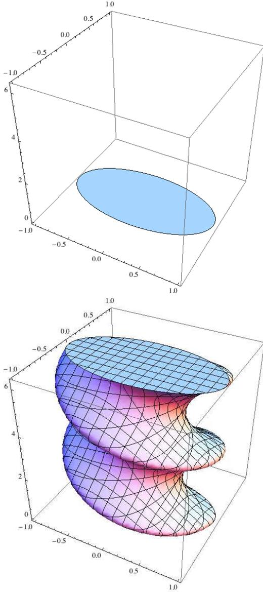
FIGURE 4 – Ensembles dont la différence de Minkowski donne la contrainte de chevauchement de deux ellipses, lorsque la rotation est prise en compte. *Gauche* : l'ellipse de référence augmentée, avec la coordonnée de rotation mise à 0. *Droite* : l'ellipse mobile augmentée  $S'_M$ .
