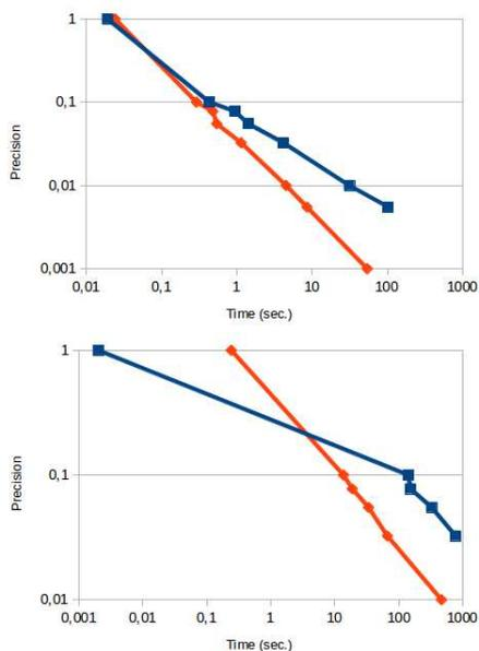
FIGURE 9 – Temps en fonction de la précision (gauche : cas 1 ; droite : cas 6). Chaque courbe représente le temps de pavage (axe vertical) en fonction de la précision  $\varepsilon$  (axe horizontal). Les deux axes sont en échelle logarithmique.
