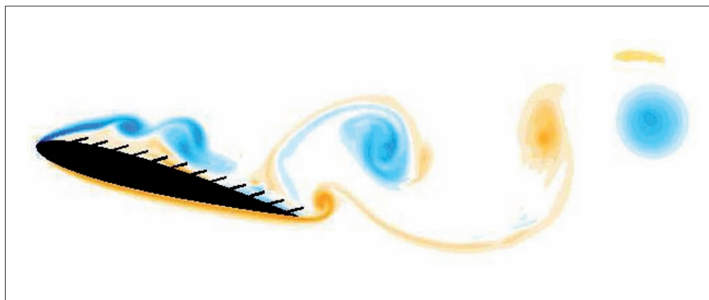
Fig. 9. Istantanea del campo di vorticità prodotto da un profilo alare per un numero di Reynolds pari a 10.000. Si osservi la formazione di vortici che si staccano dallo strato limite superiore dell'ala.
