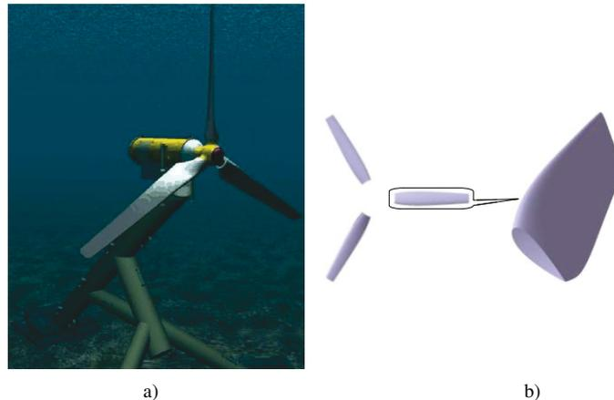
**Figure 5.** a) exemple d'hydrolienne tripale [©Strøm AS] ; b) maillage des pales
