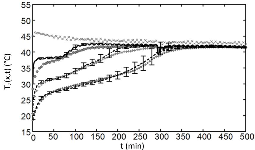
Figure 10 : Températures de l'air en fonction du temps pour les résultats expérimentaux en  $A_1$  (x),  $A_2$  (points),  $A_3$  (croix) et  $A_4$  (losanges) et numériques en  $A_1$  (x),  $A_2$  (continu),  $A_3$  (trait-point) et  $A_4$  (trait s)  $v_a=2.1\text{m.s}^{-1}$
