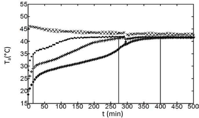
Figure 4 : Température de l'air en fonction du temps (Résultats expérimentaux) pour une vitesse  $v_a=2.1 \text{ m.s}^{-1}$  à  $A_1$  (lettre  $x$ ) ; in  $A_2$ (points),  $A_3$  (croix) and in  $A_4$  (losanges)
