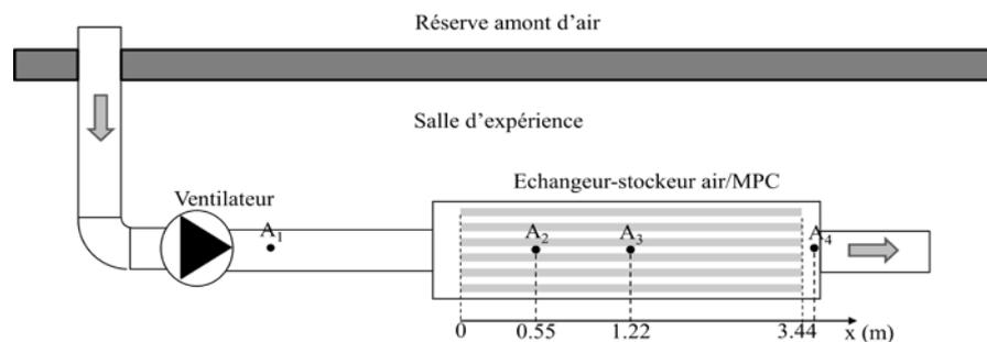
Figure 3 : Schéma du dispositif expérimental; A<sub>1</sub>, A<sub>2</sub>, A<sub>3</sub>, A<sub>4</sub>: Thermocouple de type K (mesure de la température de l'air)
