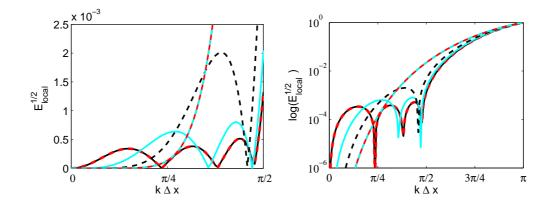
Figure 7: Local error in the wavenumber space for the optimized interpolation with order constraints for a stencil size N = 8. Interpolation of order (o.) : o.0 (----), o.2 (----), o.4 (----), o.6 (----), o.8 (----). Lagrange interpolation for N=8 (----).
