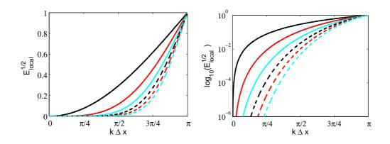
Figure 4: Local error in the wavenumber space for the Lagrange interpolation with stencil of size N=2 (---), N=4 (---), N=6 (---), N=8 (---), N=10 (---), and N=12 (---). Linear scale on top, and logatirhmic scale on bottom.
