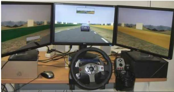
(a) Dispositif du simulateur de conduite.
