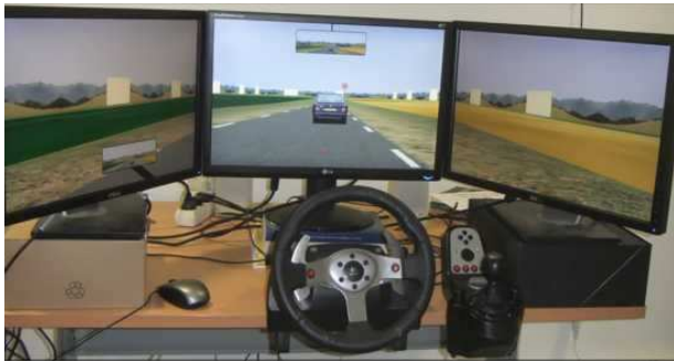
(a) Dispositif du simulateur de conduite.
