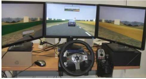
(a) Dispositif du simulateur de conduite.
