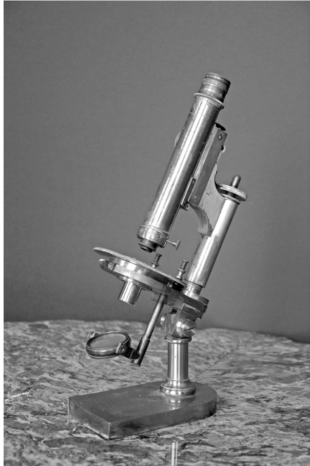
Fig. 3 : Le premier modèle de microscope polarisant construit par Emile Bertrand, alors qu'il était encore étudiant à l'Ecole des mines (Musée ENSMP). Photo José-Marcio Martins da Cruz, École des mines, Paris.
