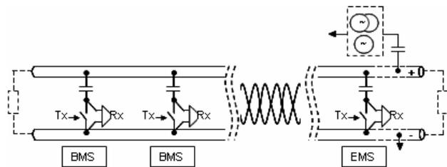
Figure 1b : Principe simplifié du bus CAN-CPL
