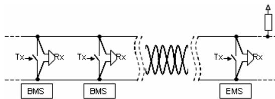
Figure 1a : Principe simplifié du bus CAN
