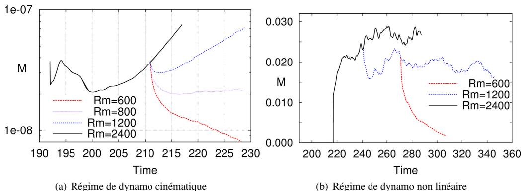
FIGURE 1 – Evolution temporelle de l'énergie magnétique  $M$  dans le fluide conducteur (a) dans le régime de dynamo cinématique de  $t = 192$  à  $Re = 1200$  et pour différents  $Rm$  (en échelle lin-log) et (b) dans le régime de dynamo non linéaire à  $Re = 1200$  et  $Rm = 2400$ ,  $Rm = 1200$ ,  $Rm = 600$ .
