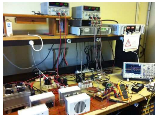
Figure 7 : Photo du banc de test de vieillissement
