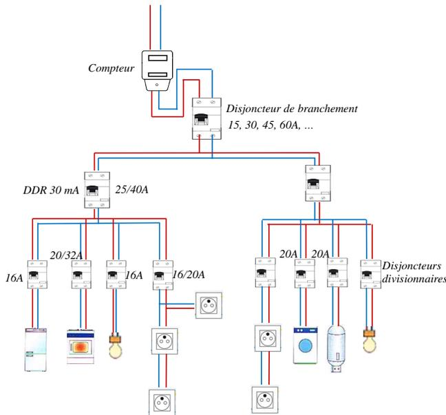
Fig.1 Réseau électrique domestique respectant la norme NFC 15-100 [1]
