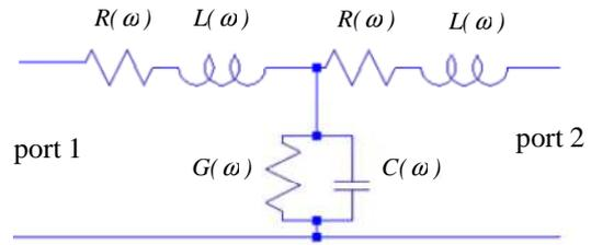
Fig.7 Circuit équivalent d'un disjoncteur.  $R$  et  $L$  représentent la résistance et l'inductance du conducteur,  $C$  la capacité entre phase et neutre et  $G$  les pertes dans le diélectrique.
