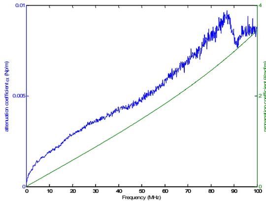
Fig. 15 Coefficient de propagation  $\gamma = \alpha + j\beta$  des cables utilisés
