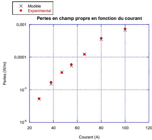
Figure 10 : Pertes expérimentales et numériques en fonction du courant sinusoïdale
