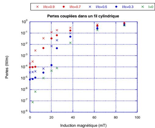
Figure 6 : Pertes couplées pour un tube supraconducteur
