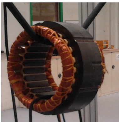
Fig. 8. Machine synchrone servant à la validation expérimentale du modèle analytique modes propres avec une machine synchrone
