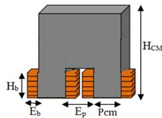
Figure 4 : Paramètres du capteur CF utilisé
