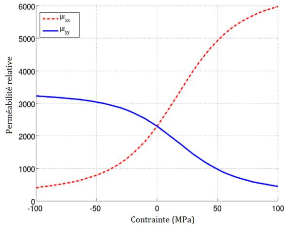
**Figure 1 : Composantes du tenseur de perméabilité relative en fonction de la contrainte appliquée pour un alliage de FeCoV (contrainte de traction/compression selon l'axe-X)**
