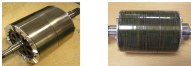
Figure 6: Images de deux frettes testées, à gauche la frette Inconel718, à droite la frette composite
