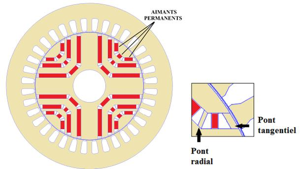
Fig.1 Structure d'un moteur synchro-réductant assisté d'aimants permanents
