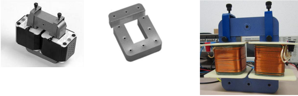
Figure 1 : Dispositif expérimental d'étude des courants de Foucault.
