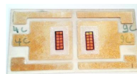
Figure 5 : Véhicule de test après le frittage d'argent.
