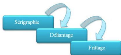
Figure 3 : Étape d'obtention d'un assemblage fritté.
