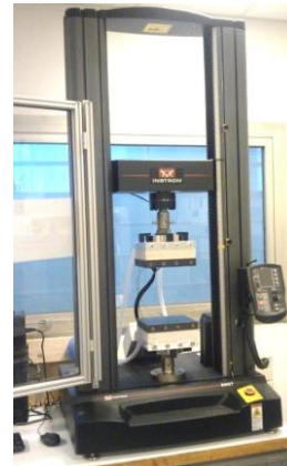
Figure 4 : Presse Instron équipée de plateaux chauffants.
