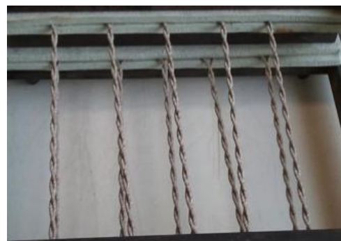
Fig.3 Dispositif de tests diélectriques pour les fils émaillés polymères et guipés
