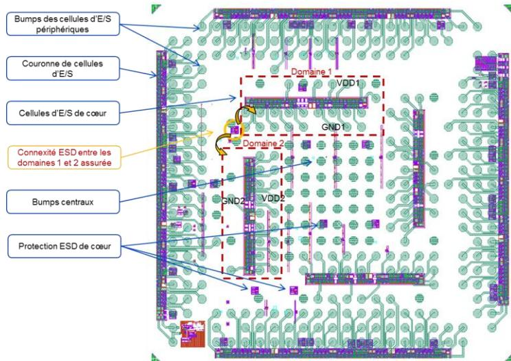
Figure 4 : Circuit « Flip-Chip » en technologie CMOS 45nm.
