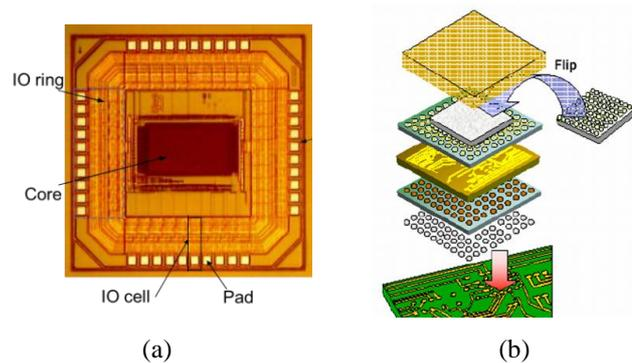
**Figure 1 : (a) Structure traditionnelle d'un circuit intégré en dehors de son boîtier. (b) Facteur d'échelle d'interconnexion entre le monde extérieur et le silicium pour la méthode d'assemblage « Flip-Chip ».**
