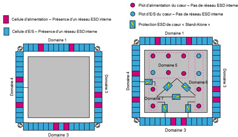
**Figure 3 : (a) Configuration classique d'un circuit intégré. Le cœur est entouré d'un anneau de cellule d'E/S. (b) Configuration « Flip-Chip ». Des éléments de protection ESD sont disséminés dans le cœur.**
