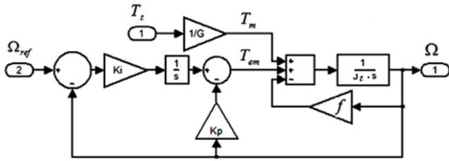
Fig.7 : Principe de contrôle de la vitesse du générateur.
