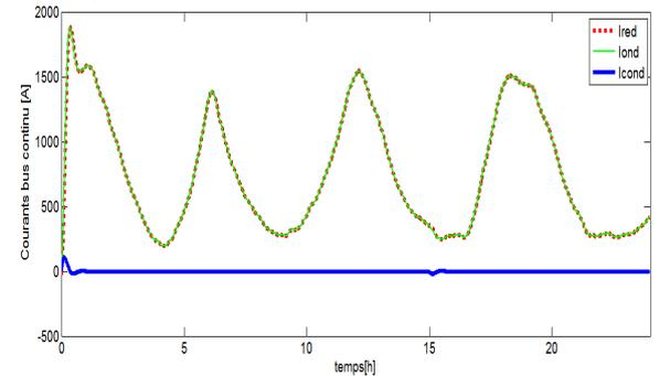
Fig.15 : Courants mesurés sur le bus continu.
