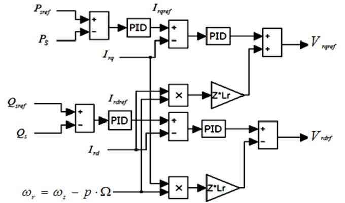
Fig. 8 : Principe de contrôle des puissances.
