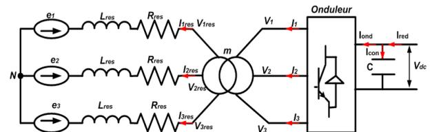
Fig.2: Modèle du réseau électrique.
