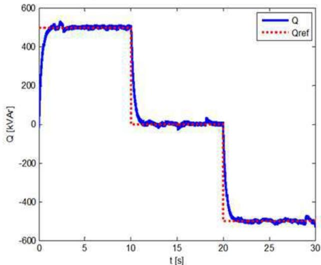
Fig.10: Résultat de contrôle de la puissance réactive.
