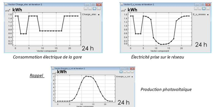
Fig. 9: Focus sur une optimisation dans la zone 200€/m<sup>2</sup> à 450 €/m<sup>2</sup> : la « Consommation électrique de la gare » et la « production photovoltaïque » sont des paramètres d'entrée, mais « l'électricité prise sur le réseau » est un résultat d'optimisation
