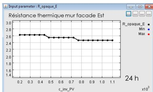
Fig. 12: Evolution de la résistance thermique des murs
