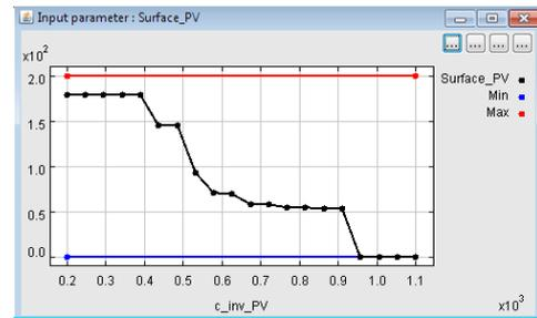
Fig. 8: Taille optimale de panneaux solaires (en m<sup>2</sup>) en fonction du coût de la technologie de panneaux solaires (en k€/m<sup>2</sup>) – Chaque point correspond à une optimisation réalisée en faisant varier  $c_{inv\_PV}$  entre 200 €/m<sup>2</sup> et 1100 €/m<sup>2</sup>
