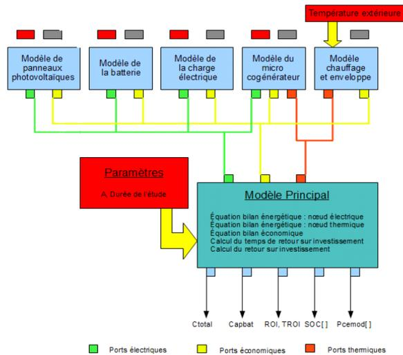
Figure 5 : Composition des modèles (équations + contraintes) à l'échelle du système via les ports (énergétiques et financiers)
