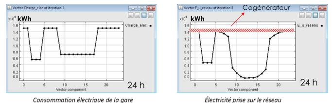
Fig. 10: Focus sur une optimisation typique dans la zone 450€/m<sup>2</sup> à 950 €/m<sup>2</sup> - La technologie co-générateur devient à présent compétitive et permet de diminuer l'énergie prélevée sur le réseau (cf. partie hachurée consommée en moins)
