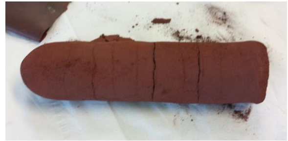
Figure 8. Le noyau avec des fissures.
