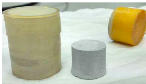
Figure 3. Moule et poudres pressés isostatiquement. L'usinage est nécessaire pour donner la forme au « cru ».
