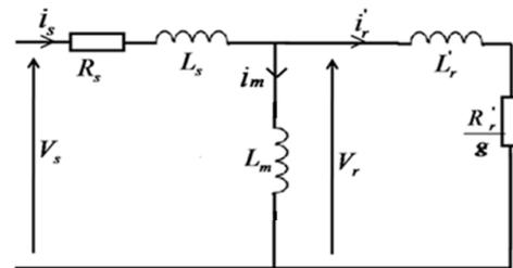
Fig.1 Schéma équivalent du moteur asynchrone à cage
