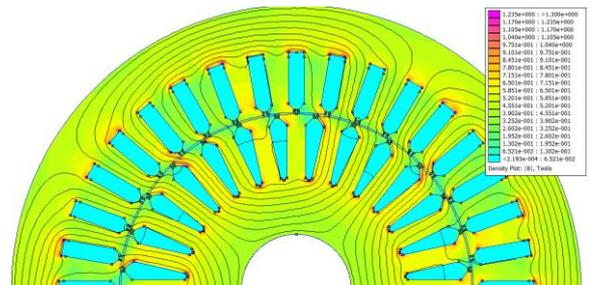
Fig.9 La distribution de l'induction dans la MAS en EF fréquentiel avec une amplitude de courant d'alimentation  $j_s=3A/mm^2$  et un glissement  $g=0.06$
