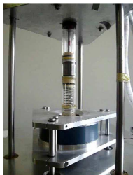
Dispositif à aimants permanents pour l'étude du cycle AMR
