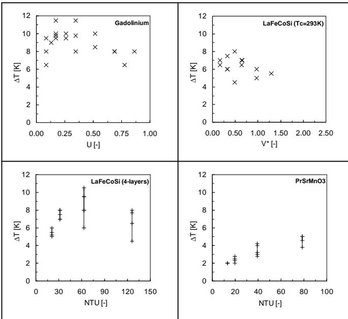
Fig. 16. Etude comparative des performances de 4 régénérateurs en Gd, LaFeSiCo et oxyde manganite.
