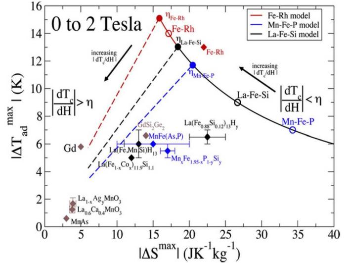
Fig. 6.  $|\Delta T_{ad}^{max}|$  en fonction de  $|\Delta S^{max}|$  pour plusieurs compositions, un champ de 2 T et une température de Curie autour de l'ambient. Les losanges représentent les valeurs expérimentales et les bars d'erreurs les variations en fonction de la composition. Les points représentent les valeurs théoriques, extrait de [13]
