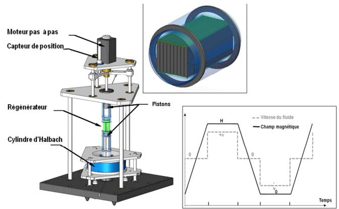
Fig. 14. DEMC, régénérateur à plaques, cycles magnétique et fluide [25].
