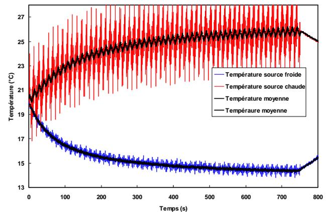
Fig. 15. Amplification de l'écart de température entre les deux extrémités du régénérateur. Régénérateur en plaques de Gd de 1mm d'épaisseur, porosité = 20%,  $\Delta T_{adia} = 1.45$  °C.
