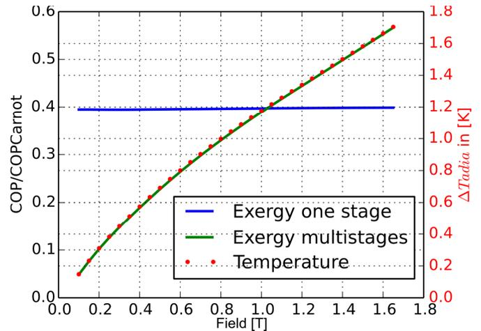
Fig. 11 Influence de la cascade d'étage sur l'exergie en fonction du champ appliqué, en comparaison d'un étage où le champ est imposé à 1 T. Le point de fonctionnement des étages est pour  $\Delta T_{source} = \Delta T_{adia}/2$  avec les caractéristiques du  $Pr_{0.65}Sr_{0.35}MnO_3$ .
