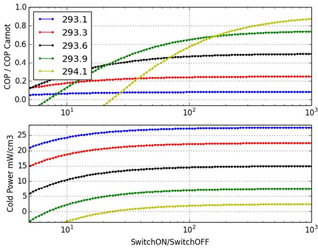
Fig. 10 Le réservoir froid est à une température  $T_{cold}$  de 293 K, la légende représente la température du réservoir chaud avec comme matériau l'oxyde  $Pr_{0.65}Sr_{0.35}MnO_3$  sous 1 T ( $\Delta T_{adia} = 1.2$  K)
