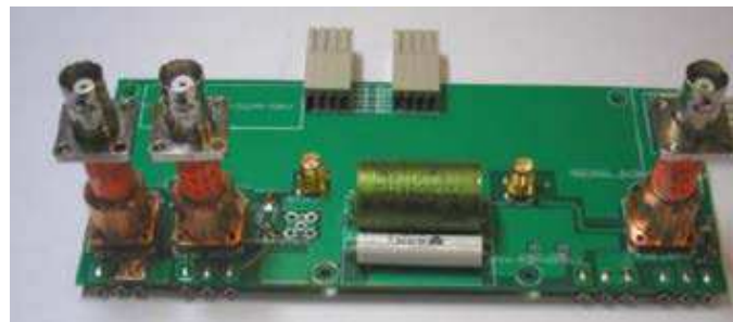
Figure 3 : Carte du bras d'onduleur réalisée
