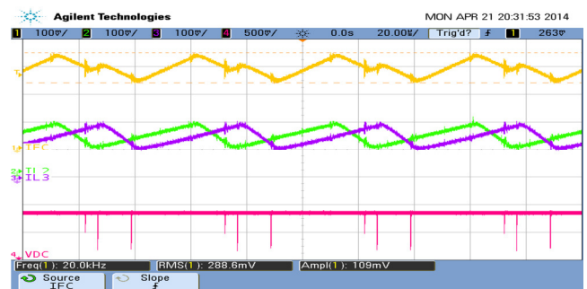
Fig.8. Impact d'un fonctionnement en mode dégradé sur le courant d'entrée du convertisseur pour un rapport cyclique D=0.76 . Voie 1 : courant d'entrée (partie haute) [10mV/A], Voie 2 : courant phase 2 [10mV/A] (partie milieu), Voie 3 : courant phase 3 [10mV/A] (partie milieu), Voie 4 : tension du bus DC [50V/div] (partie basse).
