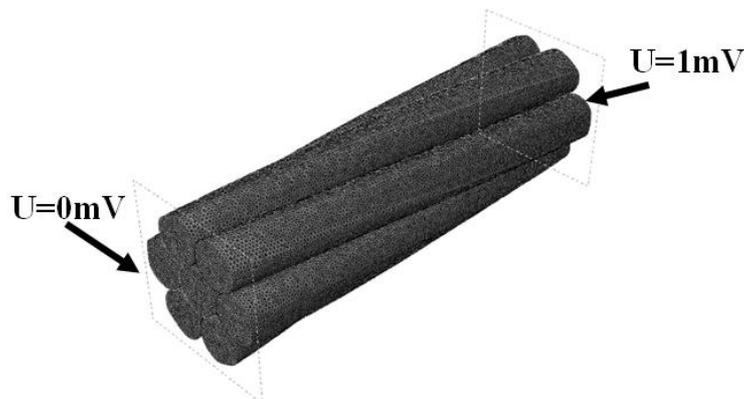
Figure 3. Les conditions aux limites du modèle électriques sur Abaqus.
