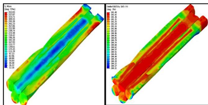
Figure 6. Répartition a) de la pression mécanique b) de la résistivité après le processus de fabrication
