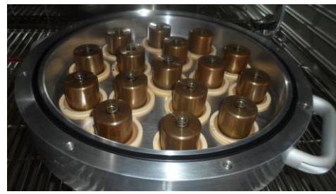
Figure 3 : Mise en œuvre des échantillons pendant le vieillissement électro-thermique
