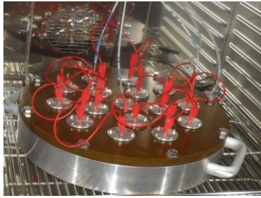
Figure 3 : Mise en œuvre des échantillons pendant le vieillissement électro-thermique
