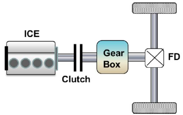
Fig.4 Schéma simplifié de la motorisation conventionnelle
