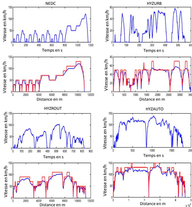
Fig.7 Cycles originaux et cycles éco en fonction du temps et de la distance
