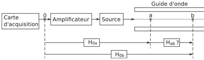
FIGURE 3 – Méthode de mesure de fonctions de transfert.
