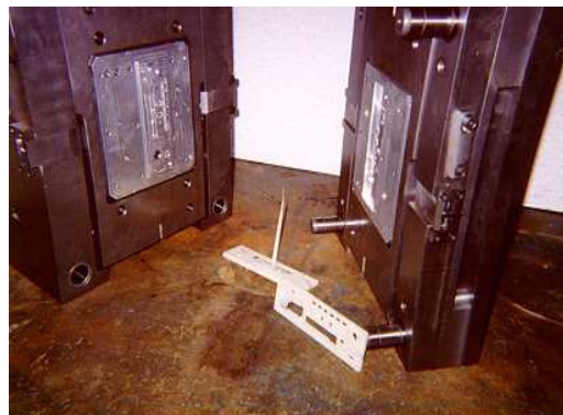
Figure 18 : moule d'injection réaliser par empilage de feuilles métalliques
