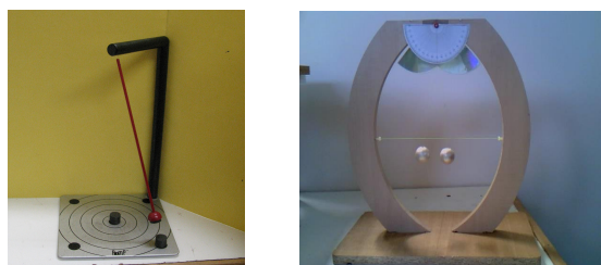
Fig 4. Image de Gauche : Pendule à masse magnétique et aimants perturbateurs. Image de droite : pendule double visualisant l'effet de la force coulombienne.
