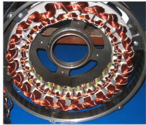
Fig.3b: Photo du stator du prototype de mscfde 24-20.
