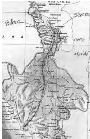
FIG. 54. Proyecto de Puente Terrestre Interocéanico. La línea curva en lápiz indica el trazado previsto, mientras que la línea recta que une bahía Gloria (antes conocida como bahía Severa) con bahía Cupica indica el trazado ideal
