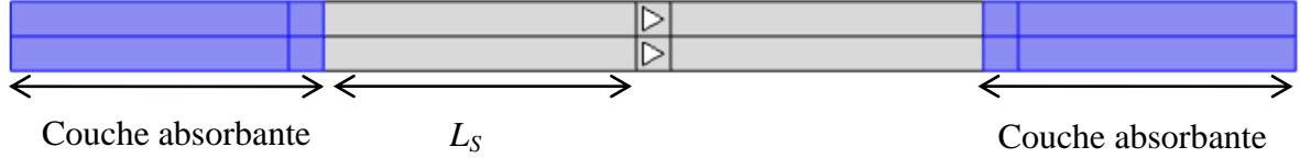
Figure 2 : La structure simulée contient ici deux rangées de cristaux. Les deux régions en bleu sont les couches absorbantes (voir section 2.2.2).
