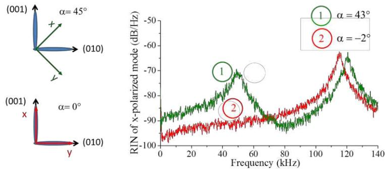
Fig. 1 : A gauche, schéma représentant deux orientations des états de polarisation  $x$  et  $y$  du laser par rapport aux axes cristallographique du Nd :YAG. A droite, spectres de bruit d'intensité relatif du mode de polarisation  $x$  pour ces deux angles  $\alpha$ .
