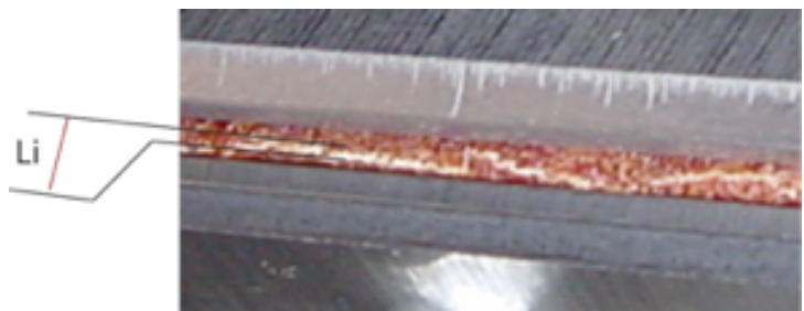
Fig. 20 : Formation d'un pli à l'échelle du papier
