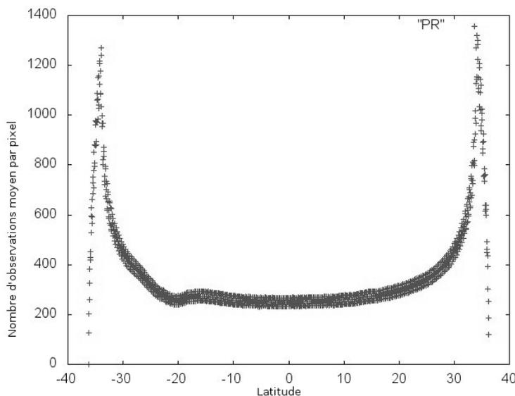
L'irrégularité à 20°S est causée par l'interruption des capteurs au-dessus du site de télémétrie. Il ressort de cette figure que la faiblesse d'échantillonnage est le principal facteur limitant l'utilisation des données PR à échelle fine.
