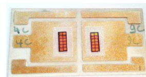
Figure 5 : Véhicule de test après le frittage d'argent.
