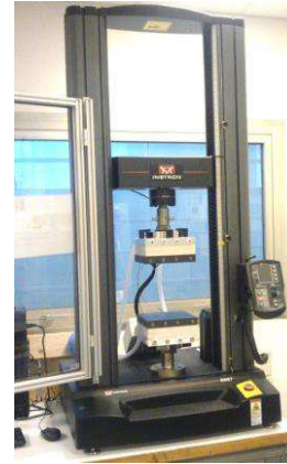
Figure 4 : Presse Instron équipée de plateaux chauffants.
